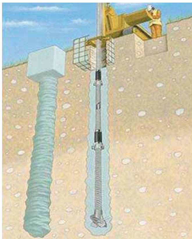
Ryc. 3. Wykonawstwo specjalnych robót geotechnicznych – mikropale
