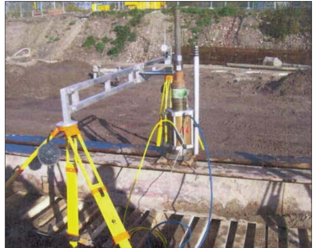
Fot. 5 | Próbné obciążenia mikropala energetycznego
