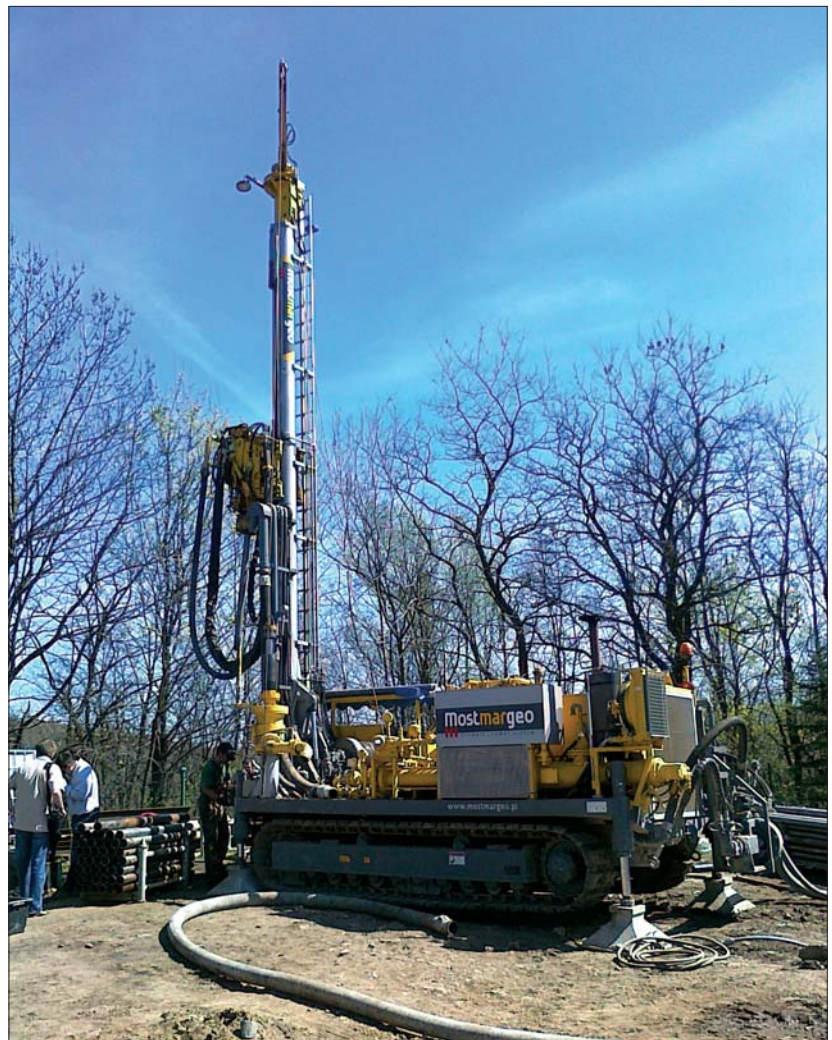
Fot. 1 | Urządzenie wiertnicze – Nordmeyer DSB2/10 (fot. archiwum Mostmarpał)
